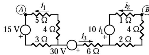
3.- Hallar  $v_{AB}$  [0.6], las intensidades indicadas de cada rama [0.4] y la potencia que absorbe cada rama de terminales  $A$  y  $B$  [0.4].
