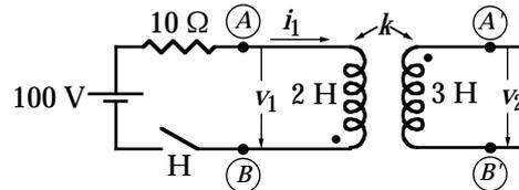
2.- Hallar las intensidades indicadas [0.6], la tensión  $v_{AB}$  [0.4], la potencia que entrega cada fuente [0.9] y la potencia que absorbe cada resistencia [0.4].
