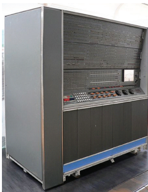
Computador IBM 7030, de 1961, con 17.000 transistores
