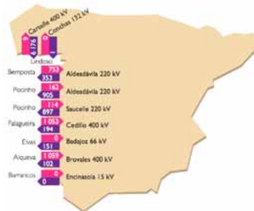
Fig. 7.- Energía eléctrica en GWh intercambiada en 2006 entre España y Portugal por cada una de las nueve líneas eléctricas que interconectan las dos naciones.
