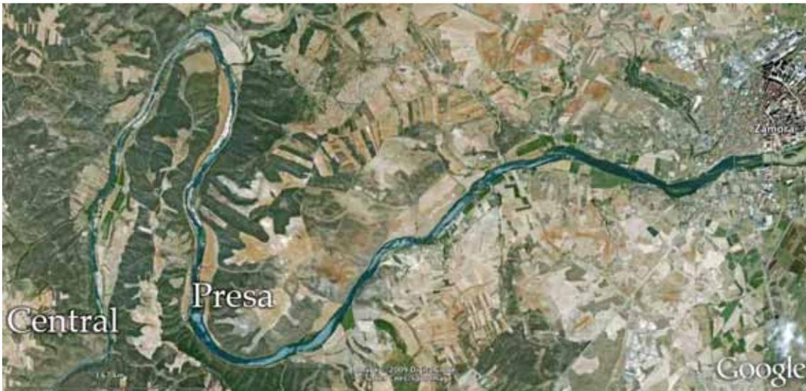
Fig. 1.- Planta hidroeléctrica de San Román de los Infantes. Un túnel horada la loma rodeada por el meandro del Duero para conducir el agua desde la presa a la central.
